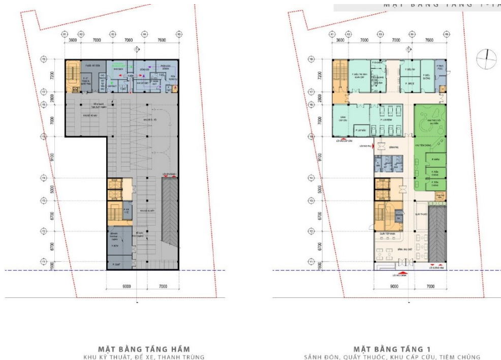
Bản vẽ thiết kế mặt bằng tầng hầm và tầng 1 của dự án
